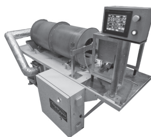
写真1 開発した遠赤外線と熱風を併用した焙煎機 ※実際の円筒部は外カバーを装着。写真はカバーを外した状態。
