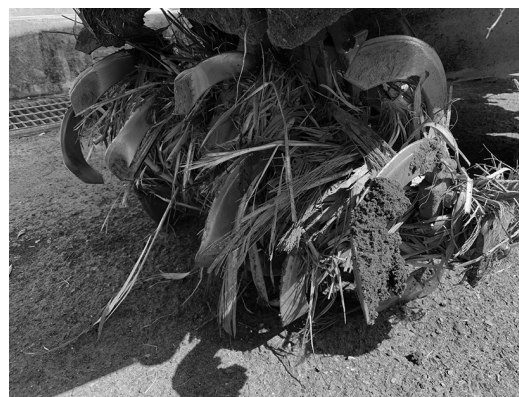
写真2 ロータリに巻き付くサトウキビの枯葉
