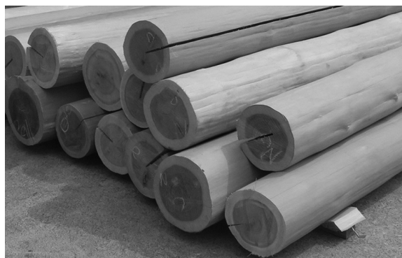
写真1 背割り加工を施した磨き丸太
