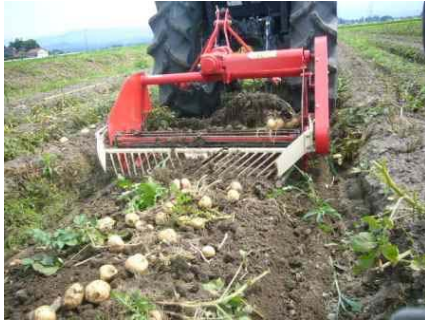
掘り取り機による掘り取り
