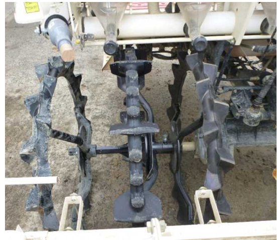
(後輪) 中央が主輪、両側がRS補助車輪
