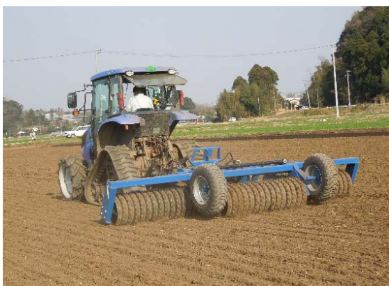
図3 大型鎮圧ローラによる鎮圧作業 (3月28日)
