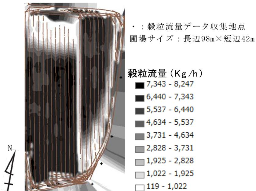
図1 収量コンバインによる圃場No. 5の穀粒流量マップ
