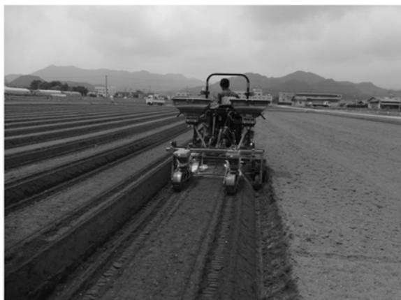
写真1 播種同時施肥機による播種作業
