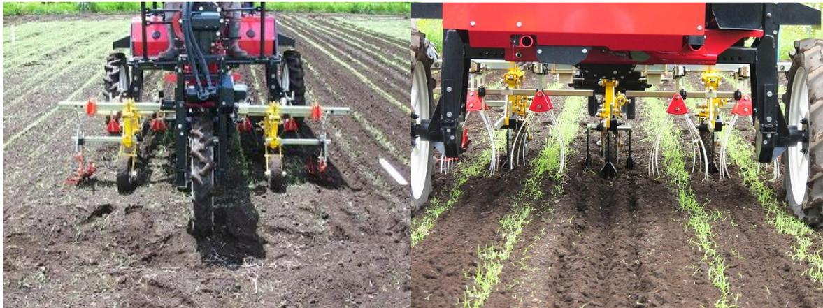
図2 ミッドマウント管理作業車（ヤンマーMD20）の除草の様子
