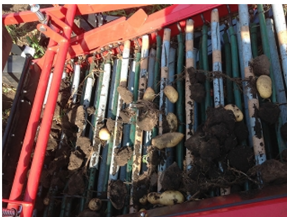
写真3 ピックアップ部の改良後
