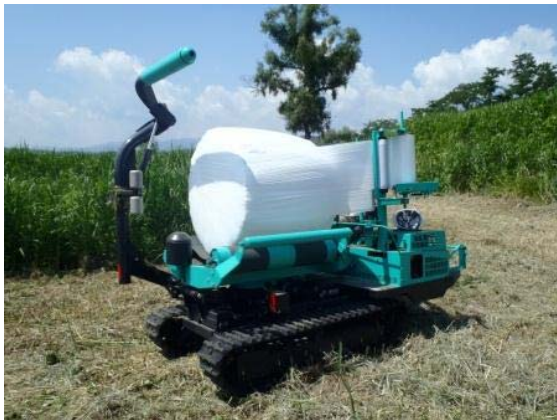
ロールバールのラッピング作業
