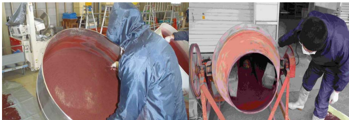
図1 種子被覆 (左: コーティングマシン, 右: コンクリートミキサー)
