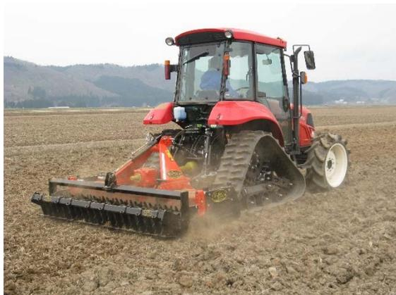
写真 縦軸駆動ハローの状況
