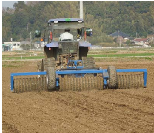
図3 大型鎮圧ローラによる鎮圧作業 (3月31日)
