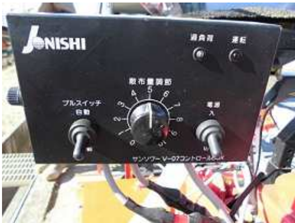
写真5：肥料の繰り出し量を変えるダイヤル
