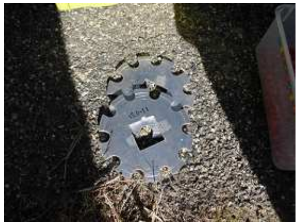
写真4：播種時の種子落下量を変える目皿
