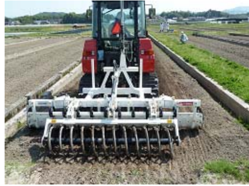
写真2 均平板(耕起幅3m)での運土作業状況 スプリングタインで砕土、膨軟 スパイラルローラで砕土、鎮圧
