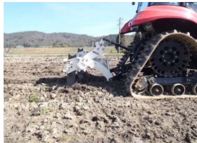
写真2 サブソイラ施工
