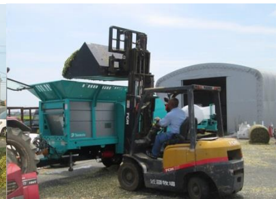
投入（バケットリフト）
