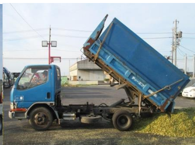
荷下ろし（2tダンプ）
