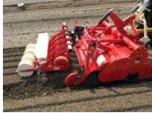
写真2 平成29年10月5日耕起同時播種の状況
