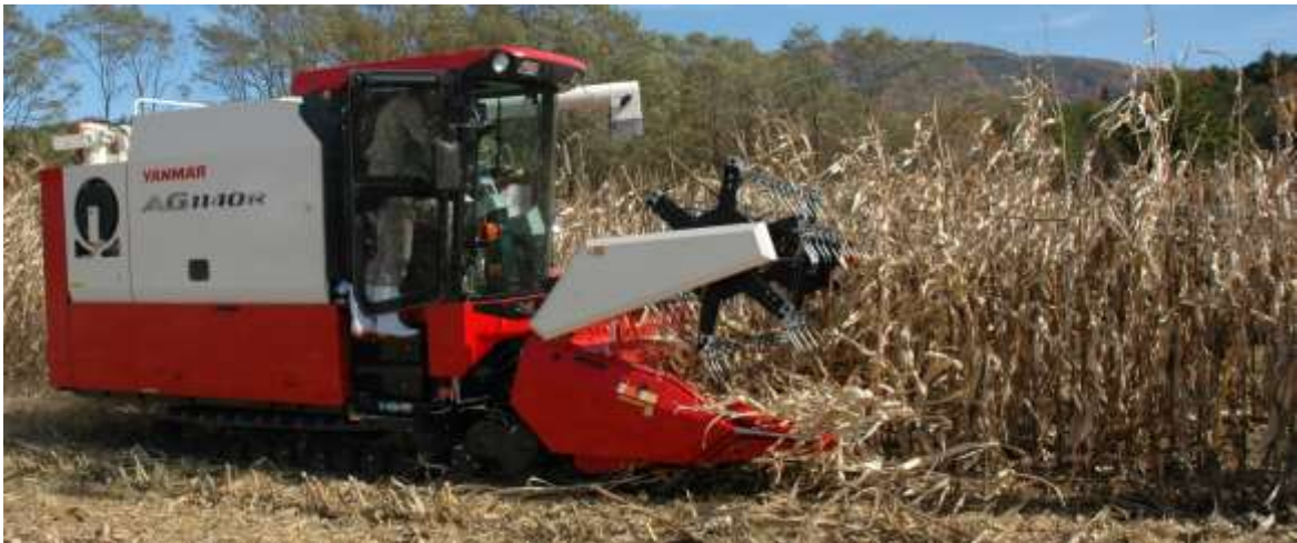
図7 汎用コンバイン AG1140R によるトウモロコシ子実の収穫（撮影：11月7日） 品種は「エスパス 95」（RM95）。昨年よりもトウモロコシがコンパクトである。
