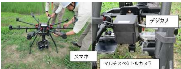
写真1：左 マルチコプター 右 使用した3種類のカメラ
