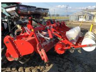
写真3 車速連動の施肥機(左上)&播種機(右)
