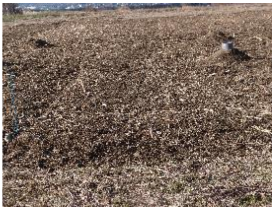
インテグレート調査 直径 20cm の塩ビ管を圃場に打ち込み 注入した水量の変化を計測
