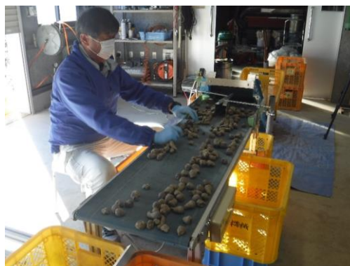
写真8 定置ベルトコンベア選別状況
