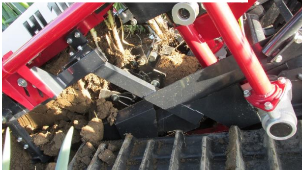
写真3 ねぎ根元の土落としロータの作動状況
