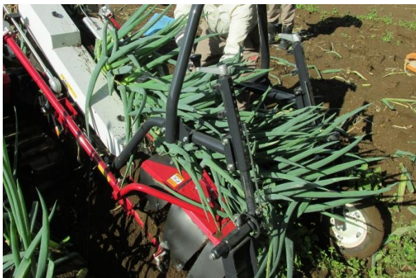
写真5 ロータ部分での詰まり (ほ場①)
