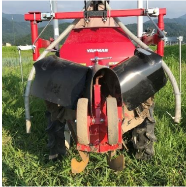
(左上)3回目土寄せ前：左下のVロータ 300Yでの土寄せ後の状態 (中央上)3回目土寄せの前処理：中央下の中耕爪軸 800UPで処理 (右上)3回目土寄せ：左下のVロータ 300Yで処理
