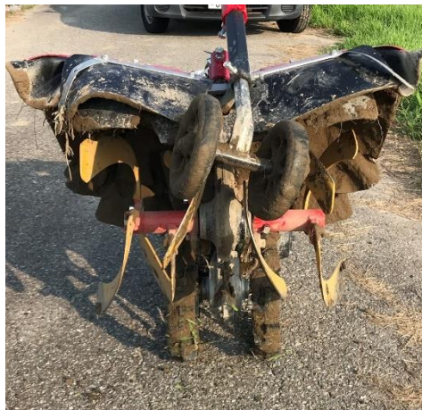
歩行型管理機のロータリ（左：28 cm幅の刃、右：50 cm幅の刃）
