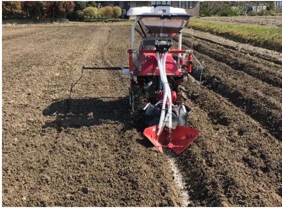
乗用耕うん機での植え溝掘り (ラインマーカでの線引、施肥、粒剤散布を同時施工)
