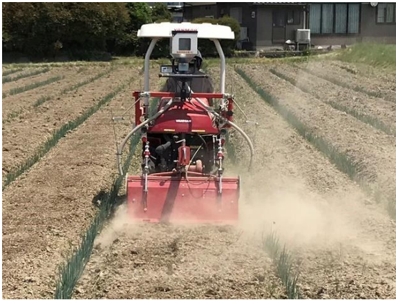
乗用耕うん機での削り込み (殺虫粒剤同時施用)
