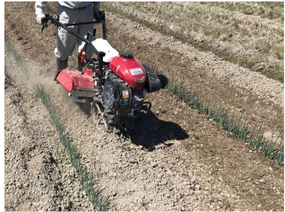
歩行型管理機での削り込み (同一条間を2回(往復)施工)
