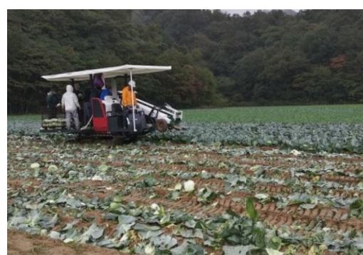
写真6 キャベツ収穫機の収穫状況
