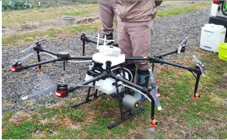
写真3 供試機体（防除用ドローン MG-1）
