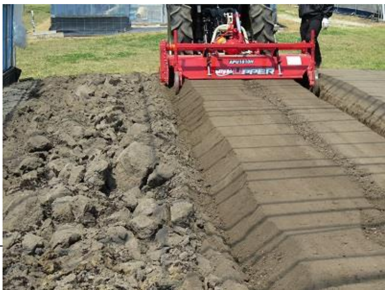
写真2 プラソイラ施工後(左半分)の 逆回転ロータリー施工 (右半分)
