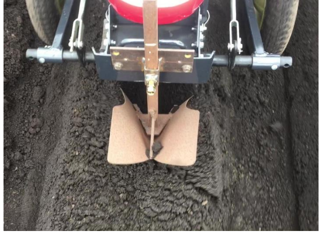
写真2 移植時の作条状況
