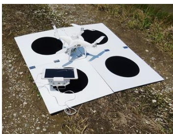
写真2. 生育量センシングに供試したドローン
