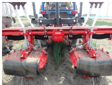
写真1 ハイクリトラクター (YT232)、ロータリーカルチ (RM212M) および施肥機 (G-F10) による土寄せ、追肥 (左: 生育初期、右: 生育後期)
