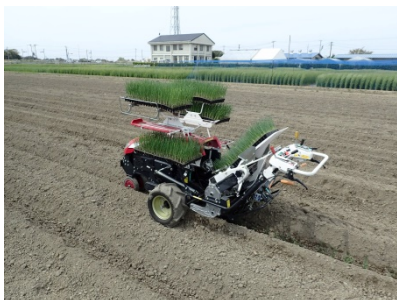
全自動移植機 (PW10N) による移植
