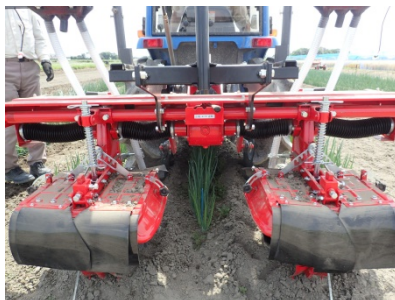
ハイクリアランストラクター (YT232)、ロータリーカルチ (RM212M) および施肥機 (G-F10) による土寄せ、追肥 (左：生育初期、右：生育後期)
