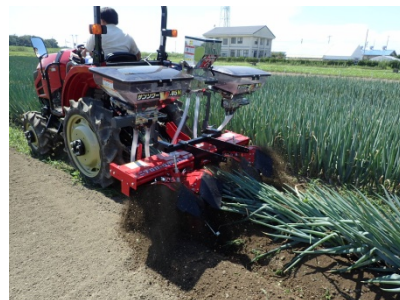
ハイクリアランストラクター (YT232)、ロータリーカルチ (RM212M) および施肥機 (G-F10) による土寄せ、追肥 (左：生育初期、右：生育後期)
