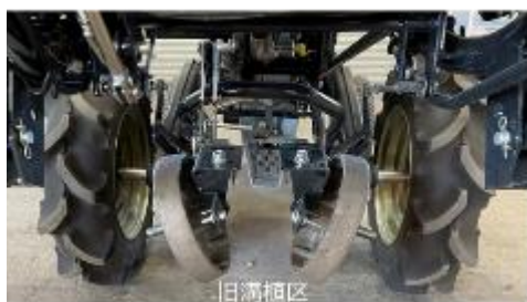
写真3 各区の鎮圧輪取付部及び鎮圧輪
