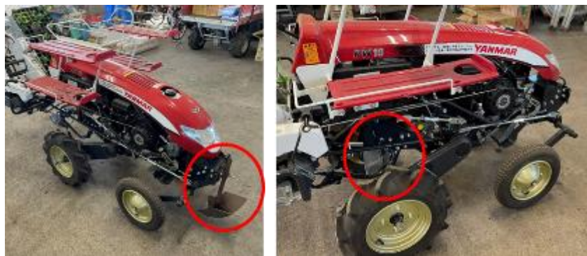
写真1 溝切り装置の取付位置(左:令和2年度試作,右:令和3年度試作)
