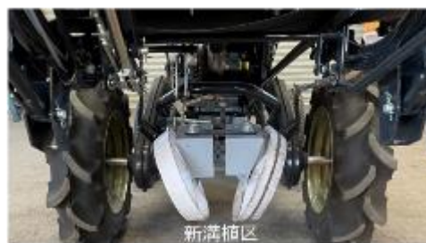
写真3 各区の鎮圧輪取付部及び鎮圧輪
