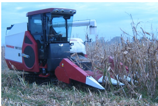
写真3. 普通型コンバイン YH700M による刈取の様子 (水田実証、白山市)
