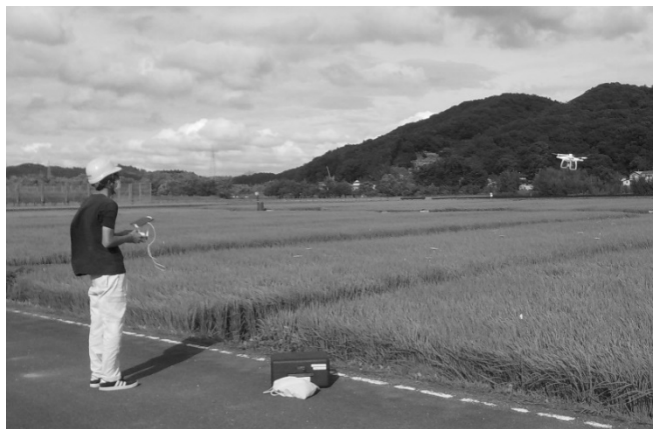
参考写真2 ドローンリモートセンシングの様子 ※実際の撮影高度は上空57m
