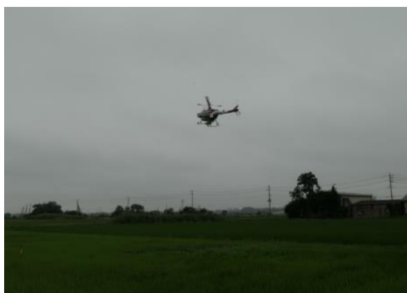
写真3. 可変施肥対応型無人ヘリによる施肥
