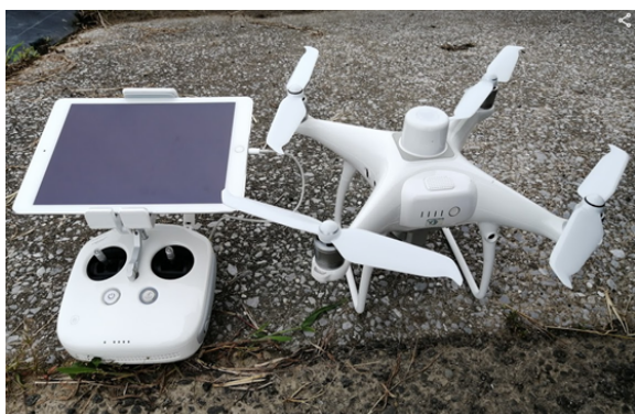
幼穂形成期のリモートセンシング (マルチスペクトルカメラ付ドローン：DJI 社製 P4MULTISPECTRAL)
