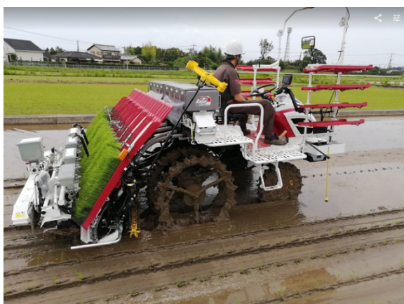
移植時の可変基肥施肥 (ヤンマー社製 可変施肥機能付乗用田植機)
