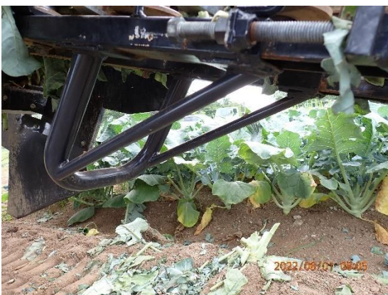
写真3 搬送部下側の部材の改良
