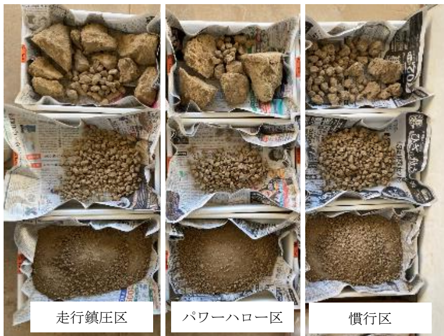
写真4 砕土率測定時 (上段 19mm 以上、中下段 19mm 未満)
