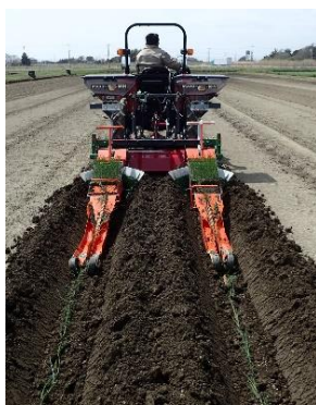
2連溝底整形機（KTA-MS01）による 植溝掘り、基肥施肥、定植
