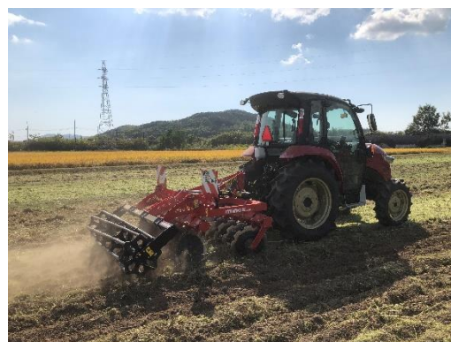
図7 ディスクティラーによる緑肥のすき込み状況(10月17日)
