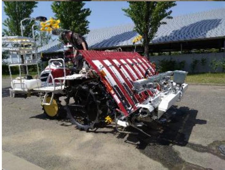
参考写真1 側条2段ペースト施肥仕様のYR-8D (ヤンマー)
