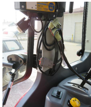
写真 トラクタキャビンフレーム部から指定ハーネスによるデータ取得
