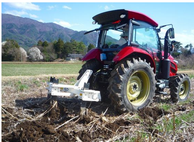
写真1 プラソイラ施工（試験1）
